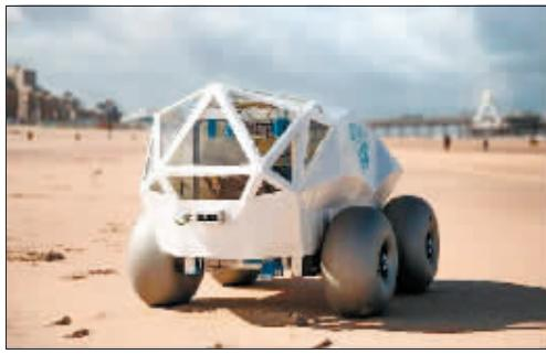
荷兰的两名企业家与荷兰代尔夫特理工大学的学生展开合作，开发出了一款海滩机器人。这个内置人工智能的机器人能识别清理海滩上的烟头。
