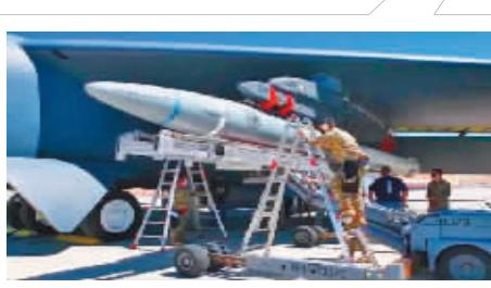
B-52H机翼下的AGM-183A导弹。
