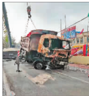
翻斗车驾驶室烧毁。
