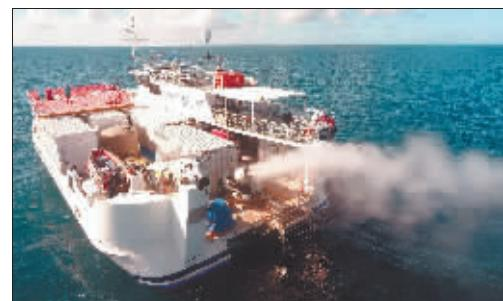
为延缓大堡礁珊瑚白化速度，澳大利亚科学家尝试将海水喷洒到空中，制造“海水云”，为珊瑚礁遮挡阳光。
