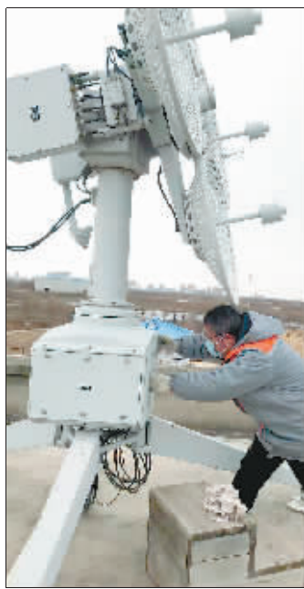
自11月2日起,全市气象部门提前深入乡镇村屯检查维护区域自动气象站,严密监测天气变化。图为呼兰区气象局观测员检查L波段二次测风雷达。
