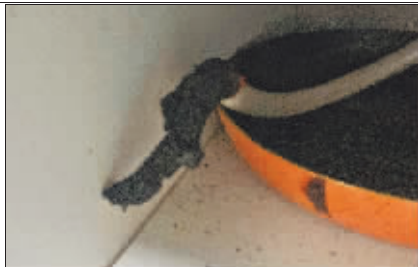
专卖店买的软管起火，烧化了。
