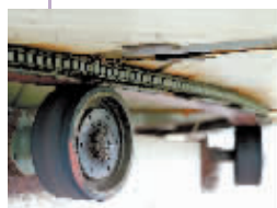
▲旋转房屋底部的传动装置。
