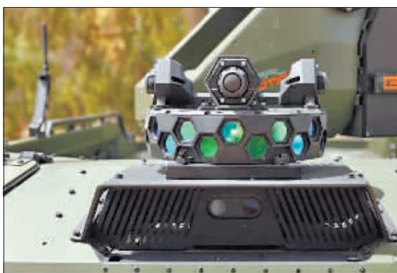
以色列航空航天工业公司13日推出一种基于人工智能技术的新型火力探测系统，它具有360度探测能力，覆盖范围广，能达到探测间接火力的目的，可在不暴露操作员位置的情况下秘密操作。这种人工智能火力探测系统被命名为“奥赛罗-P”。
