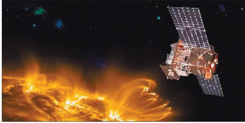
“在太阳爆发时，‘夸父一号’上搭载的全日面矢量磁像仪每18分钟就可以对全日面磁场进行一次高精度成像，有助于完整、准确地记录下太阳磁场的变化，进而侦察、破解太阳能量释放的一系列奥秘。”全日面矢量磁像仪载荷主任设计师章海鹰说，“它搭载的莱曼阿尔法太阳望远镜和太阳硬X射线成像仪，可以从紫外线、可见光和X射线波段观测太阳。
