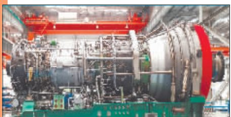
30MW级燃气轮机驱动压缩机组。
