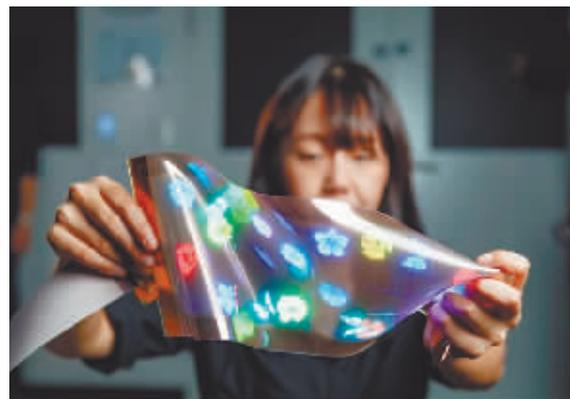
近日,LG公司发布了一款12英寸(30.48厘米)高分辨率可拉伸显示屏。这款显示屏具有橡皮筋般的柔韧性,可实现20%可拉伸性,拉伸至14英寸(35.56厘米),并且可以保持高分辨率以及优秀的耐久性。
