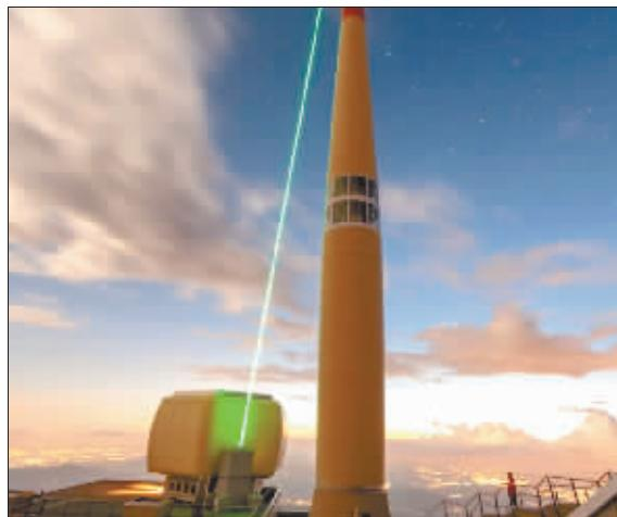
天空中闪电放电会造成相当大的损害和人员伤亡，因此除传统避雷针外，科学家也在寻求更好的保护方法。一个国际团队近日在英国《自然·光子学》杂志上发表研究说，他们成功实现了用短而强的激光脉冲在天空中形成的激光束引导闪电放电的技术。
