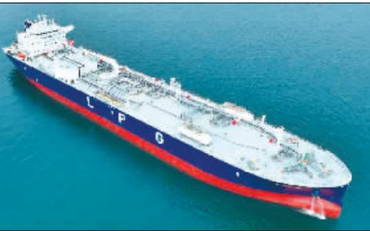
26日，中国船舶集团旗下江南造船建造的93000立方米超大型液化气船（VLGC）首制船在上海交付。江南造船在液化气船建造历史上首次实现“三合一”试航，即将常规试航、燃气试航和气体试验一次性做完，意味着船舶交付后即可投入运营。
