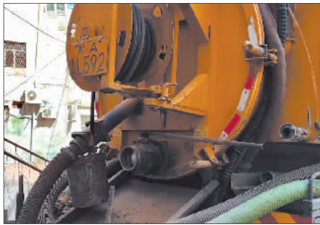
吸污车正在进行排污清掏工作。
