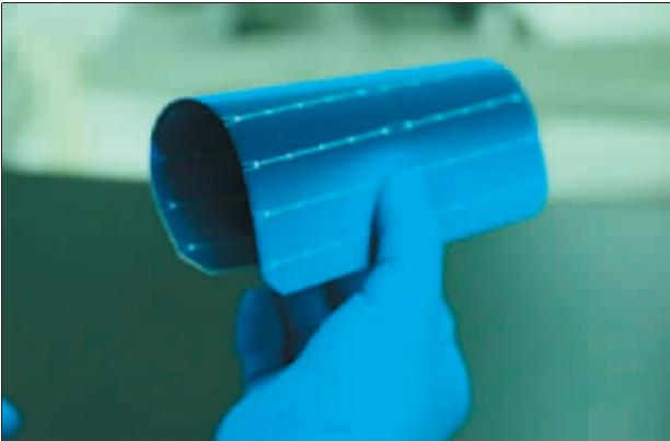
柔性太阳电池在移动通信、车载移动能源、航空航天等领域具有广泛的应用空间。近日，中科院上海微系统所的研究团队研制出可以像纸片一样弯曲，且不易断裂的高柔韧性单晶硅太阳电池。该成果在国际学术期刊《自然》发表。
