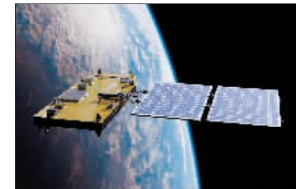
哈工大卫星已形成适应批量化生产、自动化组装、堆叠式发射的千瓦级平板式卫星平台，可为通信、雷达等卫星提供平板式型谱服务，为卫星的批量化制造和大规模星座的快速部署提供支撑。
