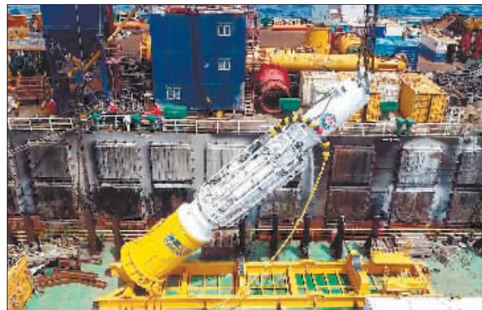
据悉，本次海试的超深水打桩锤自重约165吨，重量相当于160辆家用小汽车，总高相当于近6层楼，打桩直径可达2.5米。打桩时依靠内部构造“锤芯”撞击，将产生的冲击力散播给桩体，具有能耗低、污染少、适应性强等显著优点。
