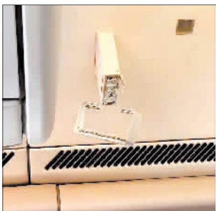
机舱顶部指示灯被撞坏。
