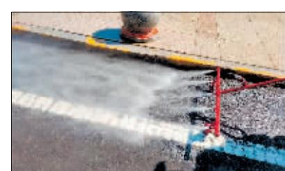
改造前，一线作业的环卫工人使用的喷洗枪多采用单喷嘴，水冲洗面积小，工作强度大。改造后，喷洗枪变为五喷嘴，水冲洗面积明显增加，单个环卫工人单次操作面积几乎提升到原来的3倍，大幅提升了作业效率。
