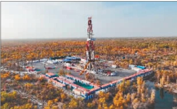
中国石化15日宣布，公司部署在塔里木盆地的中国石化“深地一号”跃进3—3XC井测试获得高产油气流，日产原油200吨，天然气5万立方米。该井完钻井深达9432米，刷新亚洲最深井斜深和超深层钻井水平位移两项纪录。
