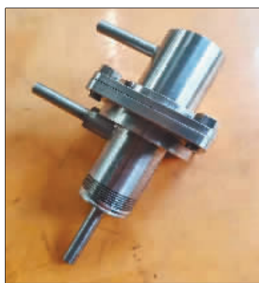
水升华器供水减压阀。
