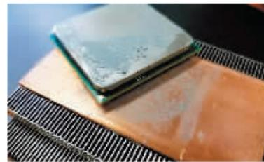
一旦电脑CPU散热器上的硅脂干了，不及时更换，非常影响CPU散热，进而降低电脑整体性能。但很少有人知道何时更换硅脂，该怎样判断呢？
