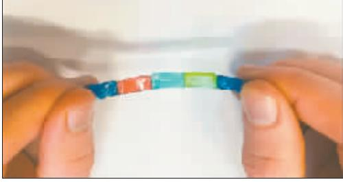
来自剑桥大学的研究人员从电鳗身上汲取灵感，开发出一种柔软可拉伸的“果冻电池”。其可自行修复，呈胶状，能拉伸至原长度的10倍以上而不影响其导电性。
