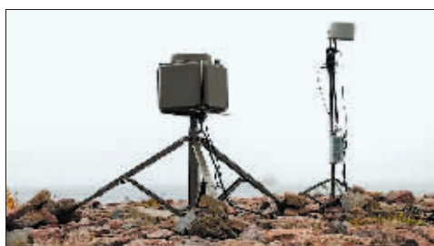
俄罗斯ROSC-1反无人机系统非常容易操作,雷达探测范围为25公里。
