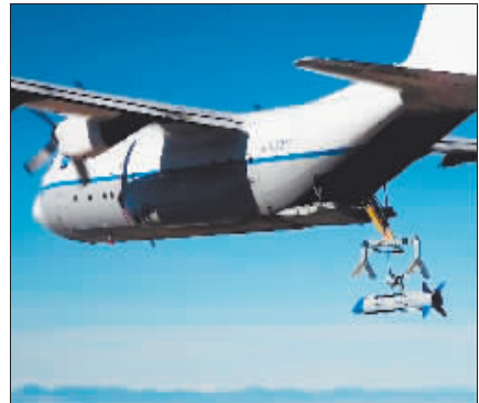
美军C-130运输机使用回收臂回收“小精灵”无人机。
