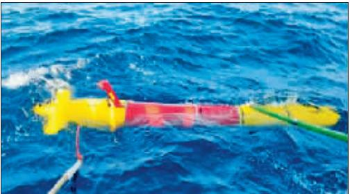
近日，天津大学机械工程学院成功研制我国首台国产深海微生物原位采样自主水下航行器（MSAUV），并通过崂山实验室组织的评审，实现了深海微生物多点位化、多尺度化、高自动化和高保真化的原位采样、保存和分析。
