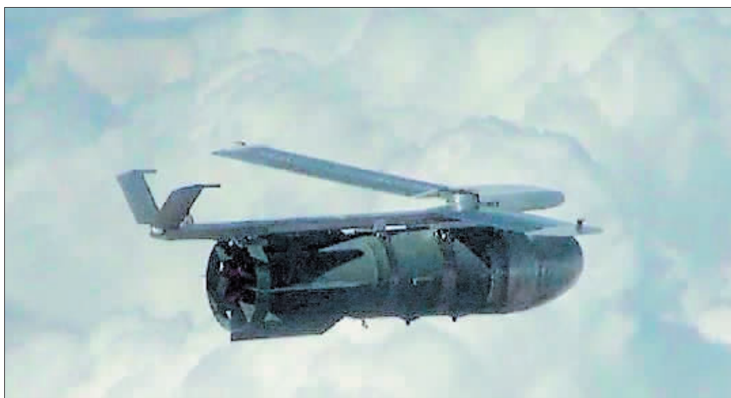
俄罗斯由FAB-3000航空炸弹改装的UMPK滑翔制导炸弹。
